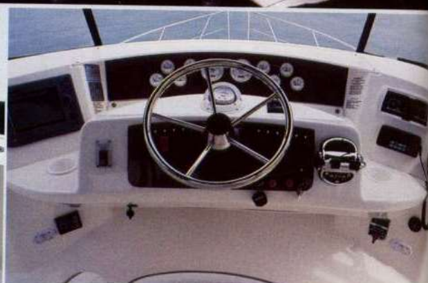
Sopra, la consolle di guida si trova solamente sopra il flying bridge e conta una dotazione completa. La timoneria ha servosterzo idraulico.
